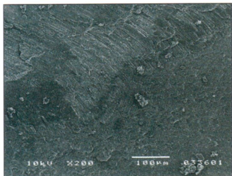
Fig. 7 - Visione al SEM del campione n.14, gruppo 2 (200x). Frattura mista, coesiva del composito e adesiva all'interfaccia dentina-composito. È ben evidente sia la presenza di dentina (in alto) che di composito (in basso) sul piattello radicolare.
