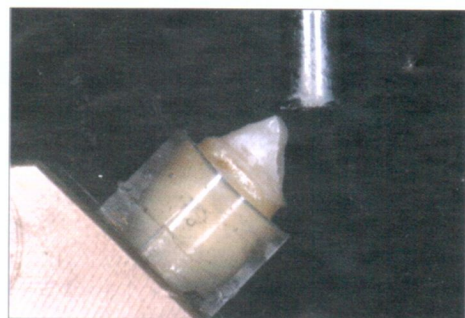
Fig. 5 - Frattura coesiva del composito. Cohesive fracture of the composite core.
