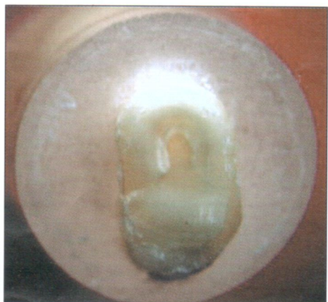
Fig. 6 - Foto al microscopio ottico (8x): campione n.14, gruppo 2. Frattura mista, coesiva del composito e adesiva all'interfaccia tra la base del moncone e la dentina.
