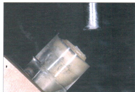
Fig. 4 - Campione inserito nel supporto metallico. Frattura alla base del moncone a seguito del test meccanico con macchina Instron.
